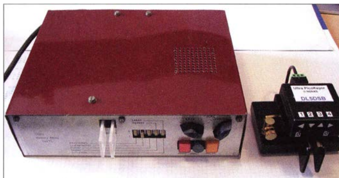
Bild 1: Historische Elbug mit integriertem Geber (Eigenbau 1980) und Paddle mit aufgesetzter moderner Keyer-Elektronik (2015) im Größenvergleich; beide beherrschen u. a. die als Ultimate Mode bezeichnete Keyer-Betriebsart.
