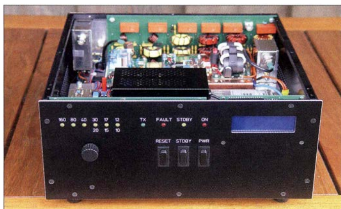
Bild 1: Frontseite der LDMOS-Endstufe mit den Bedienelementen, den LEDs zur Statusanzeige und dem LC-Display; die obere Gehäuseabdeckung wurde entfernt.
