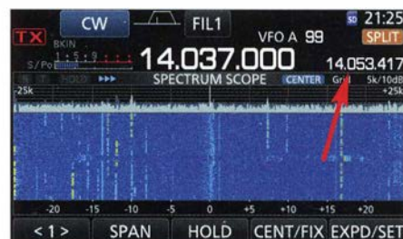
Bild 9: Wird beim Antippen des Signals gemäß Bild 8 gleichzeitig die XFC-Taste gedrückt, beeinflusst dies den B-VFO. So kann man im Pile-up die Stelle treffen, wo die DX-Station hört.
