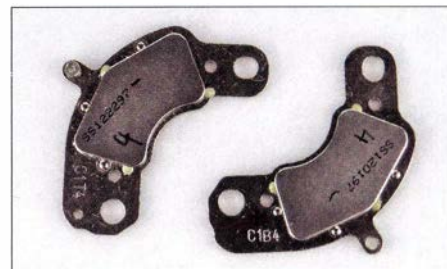
Bild 3: Neodym-Magnete einer Festplatte auf den Befestigungsplatten aus Eisen
