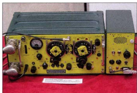
Bild 4: Aus der Sammlung von DK1JU; englischer WS19-Transceiver 2 MHz bis 8 MHz aus dem Zweiten Weltkrieg, Baujahr 1942, um 1965 im Amateurfunk eingesetzt
