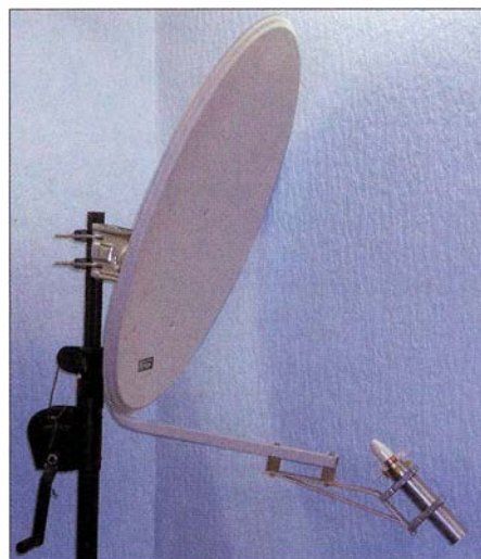
Bild 14: Offsetspiegel mit verschiebbarem Duoband-Erreger Fotos: DJ7GP
