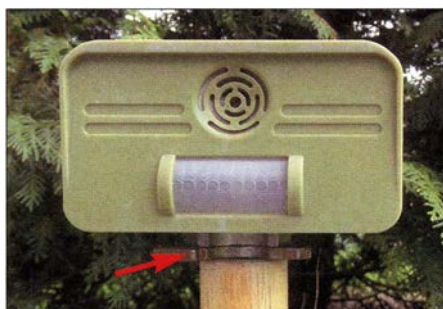
Bild 2: Lösbarer Magnetverbinder an einem Kunststoffgehäuse
