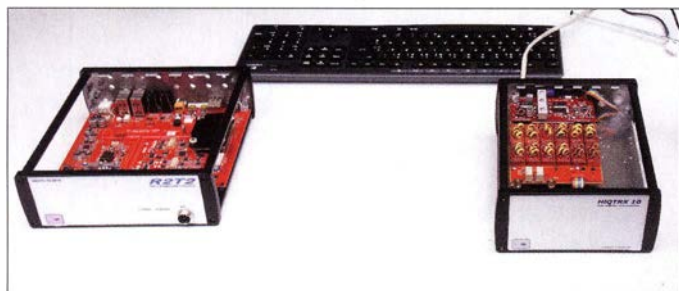
Bild 1: Musteraufbauten der SDR-Lösungen R2T2 und HiQTRX
