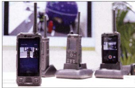
Ein smartes Funkgerät aus China mit Berührungsbildschirm und Videoübertragung
