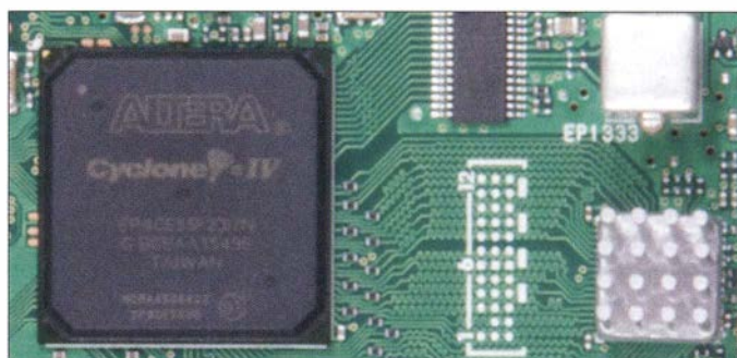
Bild 7: „Hertz“-Stück des IC-7300 ist ein FPGA, der sowohl beim Empfang als auch beim Senden viele Funktionen hat; rechts unten der A/D-Umsetzer.
