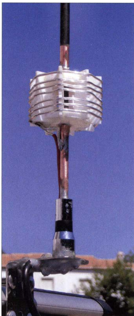
Bild 1: Komplett montierte Spule der 17-m-Mobilantenne nach dem Abgleich
