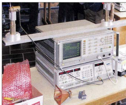
Messplatz für 10-GHz-Strahler der Jugendgruppe OV N38 Foto: DH6BB
