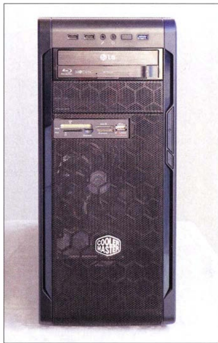
Bild 3: Komplett aufgebauter PC im Midi-Tower-Gehäuse mit DVD-Laufwerk und Speicherkartenleser auf der Frontseite
