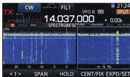
Bild 8: Beim Berühren einer Signalspur öffnet sich ein Lupenfenster, in dem man das gewünschte Signal präzise antippen kann, worauf sich der IC-7300 auf dieses abstimmt.
