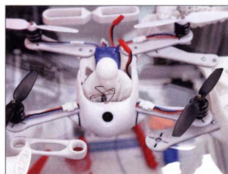
Bauteile dieser Drohne stammen aus einem 3-D-Drucker.
